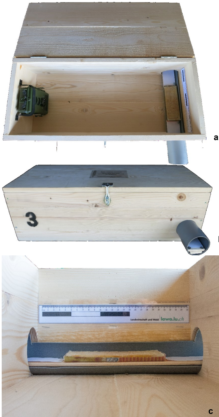
Abbildung 4: Eine der längere Fotokisten mit integrierter Kamera (a,b). Innenansicht mit Spurenblettchen und Massstab (c).
